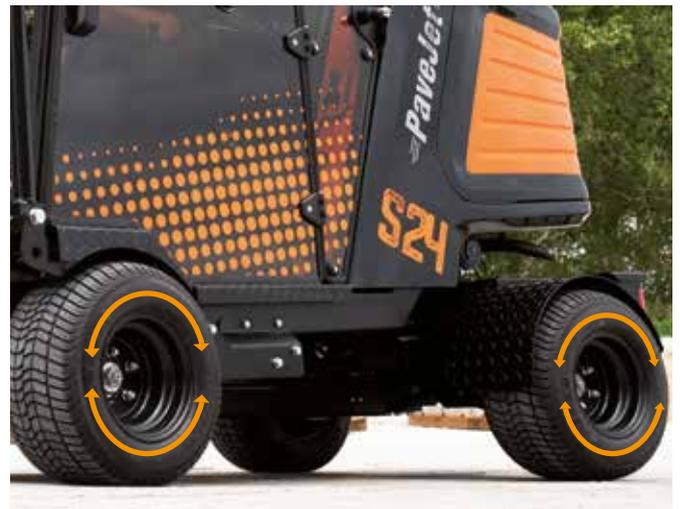
Les 4 roues sont entraînées et freinées de manière hydrostatique.
